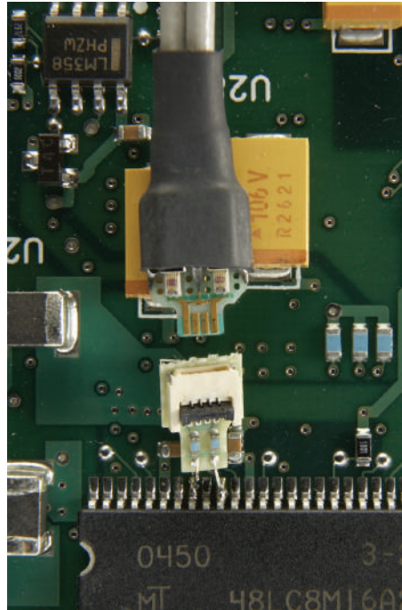
InfiniiMax ZIF tip soldered on board
